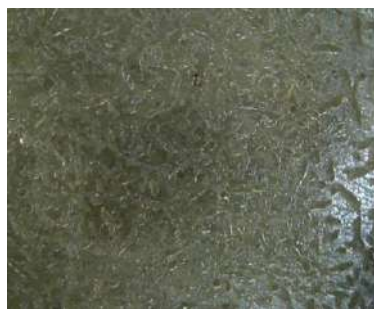
Рис. Поверхность электрода с поли – 2 – [(2E) – 1 – метил – 2 – бутен – 1 - ил] анилином, полученным в среде 1 Н \text{HClO}_4 . Снимок с оптического микроскопа \times 100 .
